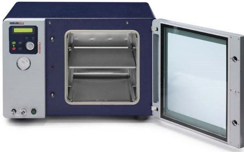
La stufa è fornita con un ripiano in alluminio (carico max 20 kg) e di attacco per gas inerte e regolazione flusso con valvola a spillo.
